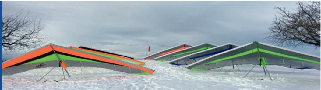
**Crex 3 14.5.m2, einziger Hängegleiter der DHV-Klasse 1 mit Doppelsegel, 23kg, Teleskopsystem 5.5/3.3m V-max. 80 km/h, Zuladung max. 98 kg**
